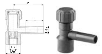
Elekterkeevissadula puurkolmik SDR 11, PN16 360° pööratava ühendusega
